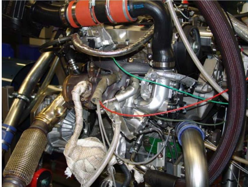
**Bild 1:** Turboladeranordnung am 2.0 l Versuchsmotor mit vollvariabler Ventilsteuerung
