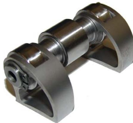
**Bild 8:** Gabelhebelausführung für ein Hochdrehzahlkonzept
